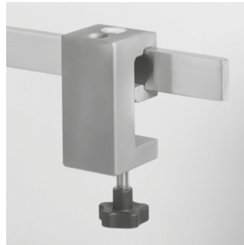
19799-06 Leichtmetall-Klemmsocket Spannweite 50 mm, für ein Schraubstativ mit \varnothing 16 mm/M10, für Schienen 25/35 x 8/10 und Rohre \varnothing 12 - 35 mm. Clamp socket made of light metal, holding width 50 mm, for screw stand \varnothing 16 mm/M10, for rails 25/35 x 8/10 and tubes \varnothing 12 - 35 mm.
