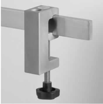
19799-03 Leichtmetall-Klemmsocket Spannweite 35 mm, für ein Schraubstativ mit \varnothing 16 mm/M10, für Schienen 25/35 x 8/10 und Rohre \varnothing 12 - 35 mm. Clamp socket made of light metal, holding width 35 mm, for screw stand \varnothing 16 mm/M10, for rails 25/35 x 8/10 and tubes \varnothing 12 - 35 mm.
