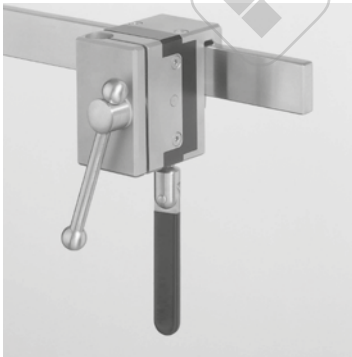
19799-05 Klemmsocket aus rostfreiem Stahl, für ein höhenverstellbares Stativ \varnothing 16 mm, elektrisch isoliert bis 4,5 kV AC, Spannweite 50 mm für Schienen 25/32 x 8/12 mm. Clamp socket made of stainless steel, for height-adjustable stand \varnothing 16 mm, electrically insulated up to 4.5 kV AC, holding width of 50 mm for rails 25/32 x 8/12 mm.
