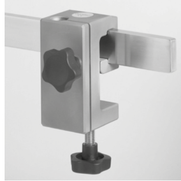
19799-04 Leichtmetall-Klemmsocket Spannweite 50 mm, für ein höhenverstellbares Stativ \varnothing 16 mm, für Schienen 25/35 x 8/10 und Rohre \varnothing 12 - 35 mm. Clamp socket made of light metal, holding width 50 mm, for height-adjustable stand \varnothing 16 mm, for rails 25/35 x 8/10 and tubes \varnothing 12 - 35 mm.
